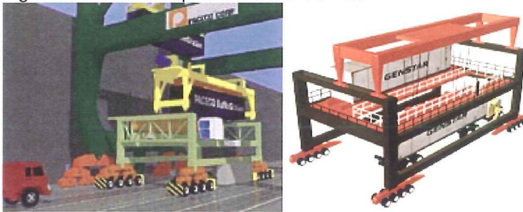
Figuur 5.14 Bufferplatform onder de kraan
