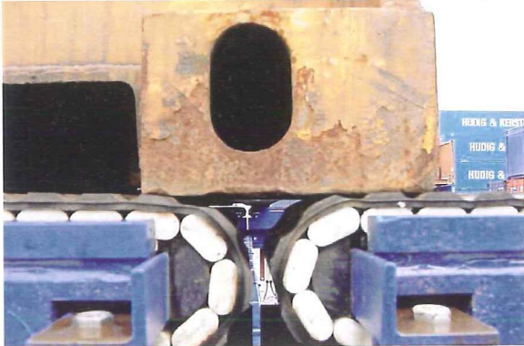
Figuur 5.15 Het Halmij continu kadetransport systeem
