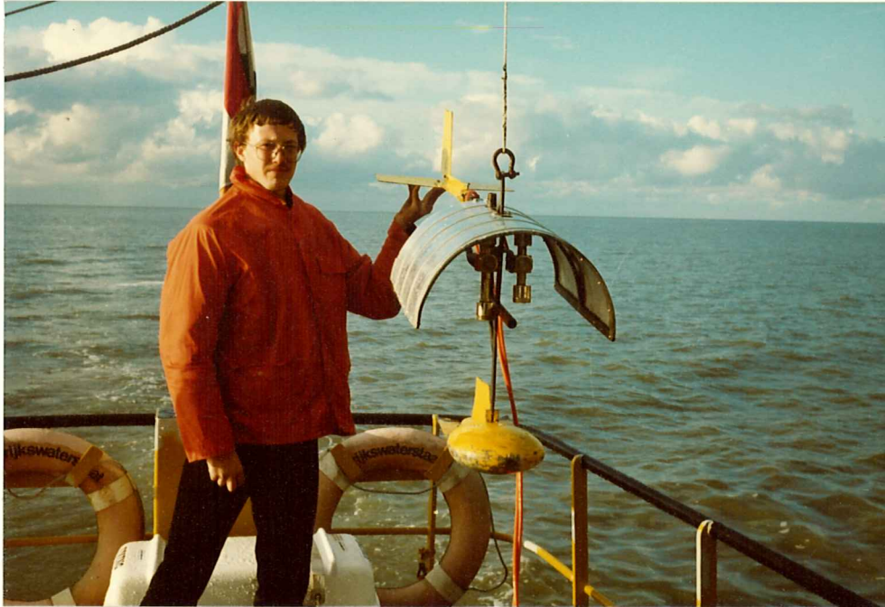
Foto 1. Frame, voorzien van gewicht, aanzuigbuis en twee Partech-sondes.
