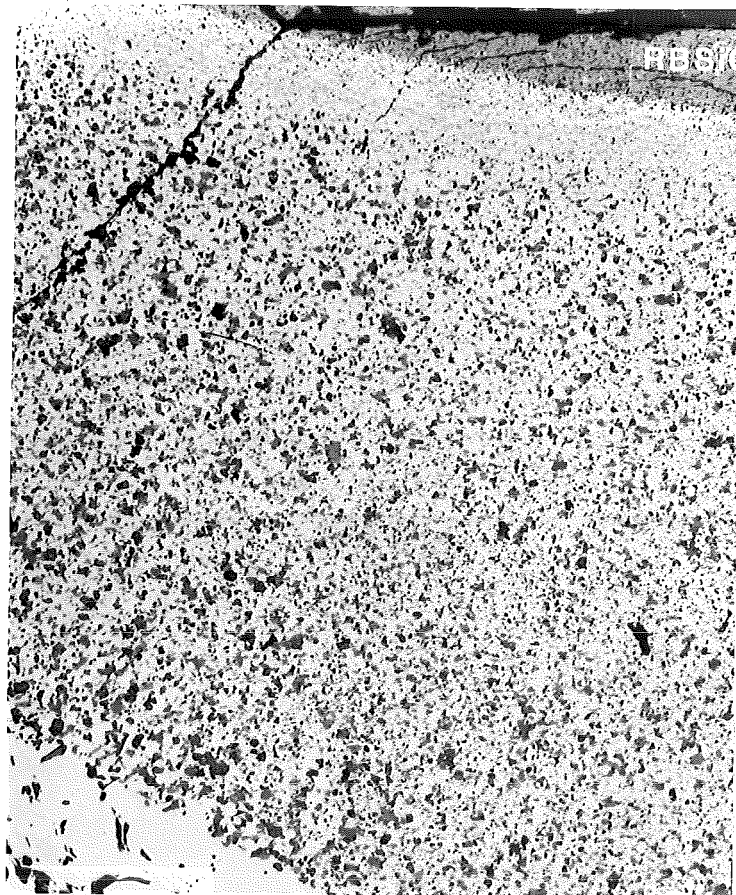
Figuur 35: Dwarsdoorsnede van de diffusielasverbinding die verkregen werd bij het experiment van 24 uur op een temperatuur van 1100 °C. RBSiC - Ni - RVS 316. Vergroting: 50x.
