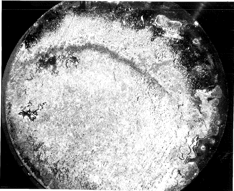
Figuur 53: De reactielaag aan het koperoppervlak van de diffusielasverbinding na het bepalen van de afschuifsterkte. HPSiC - Cu - RVS 316. Lastemperatuur: 950 °C, lastijd: 24 uur.
