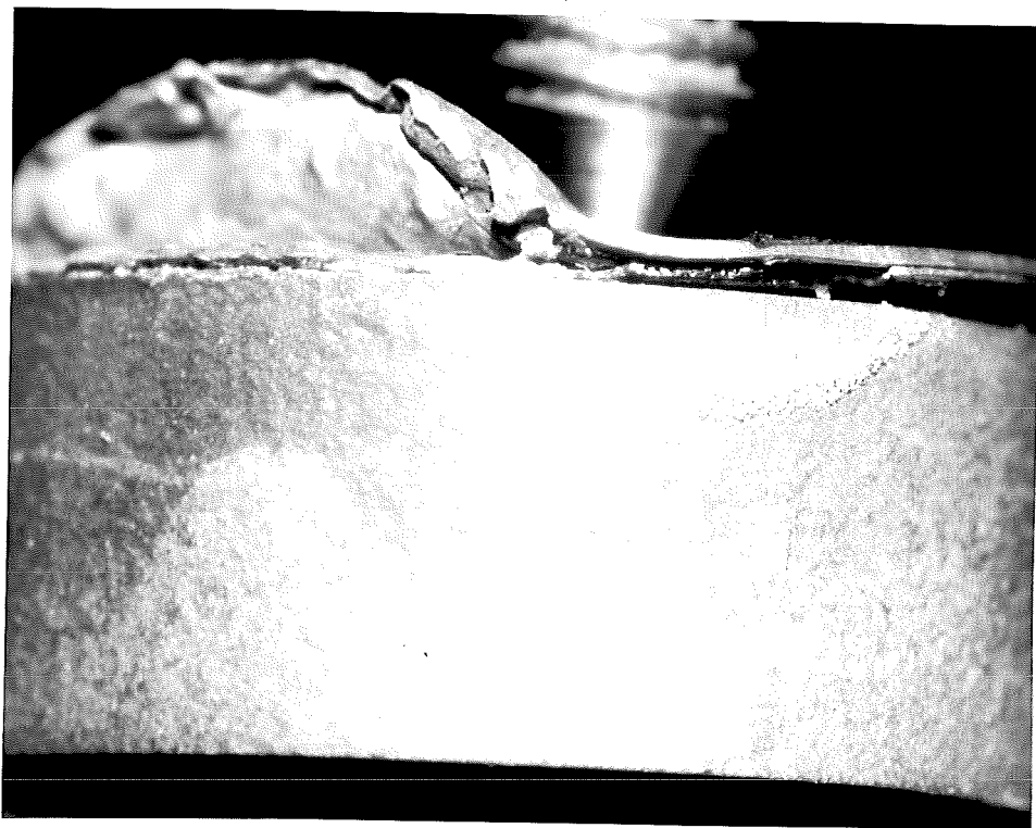
Figuur 58: De diffusielas die ontstaan was bij het experiment van 24 uur op een temperatuur van 750 °C na afschuiven. SiC - gedeelte. Vergroting: 10x.
