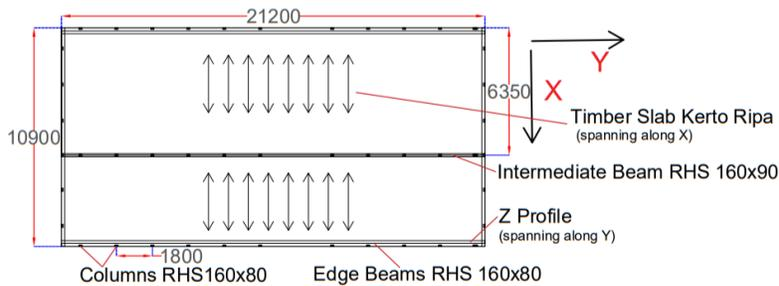
Figure 5.2: Original plan of Bouwdeel D.
