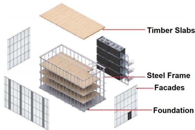
*Figure 5.1: Bouwdeel D - Kit of Parts, from [18].*
