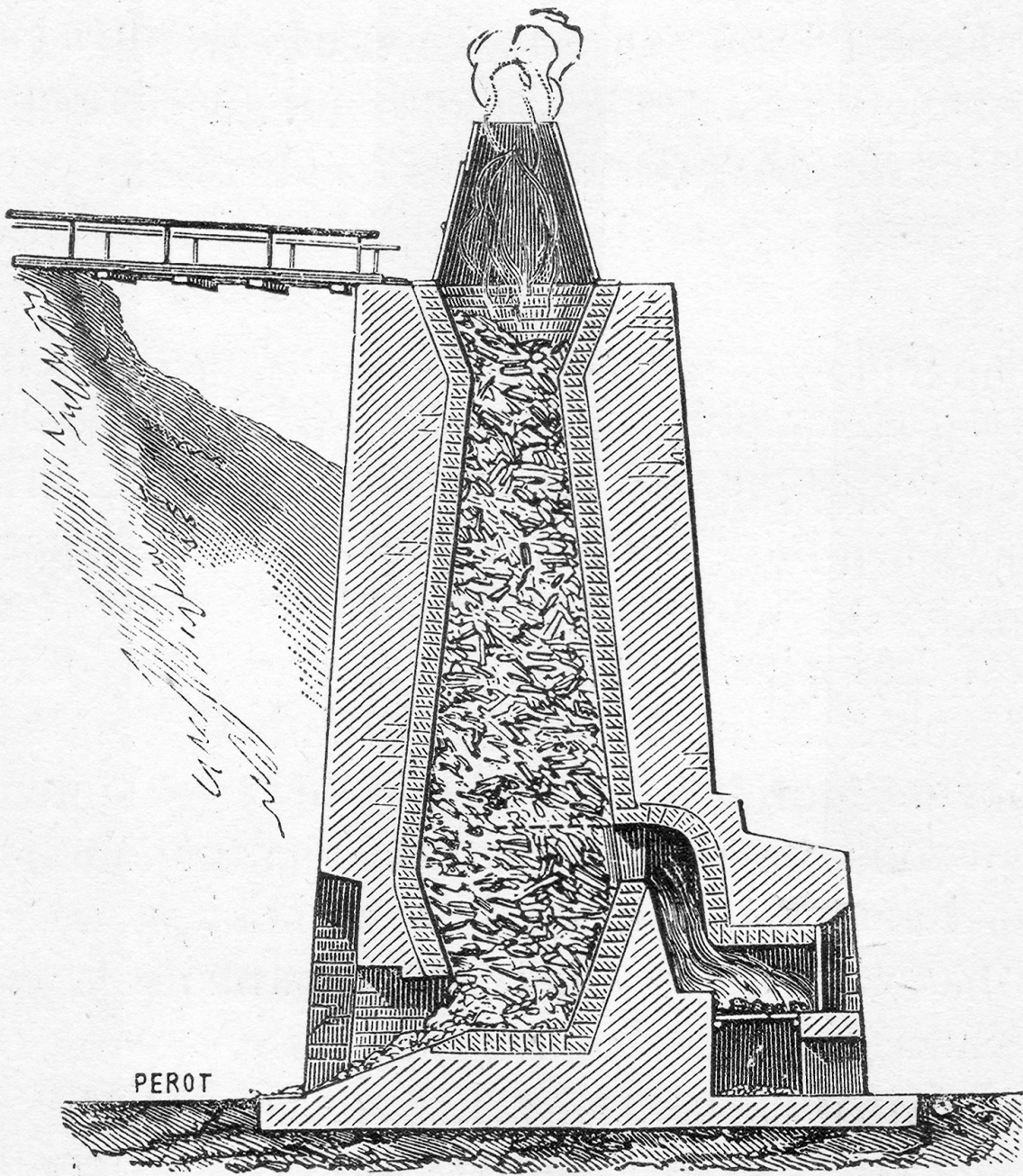
Fig. 78. — Four à chaux.
