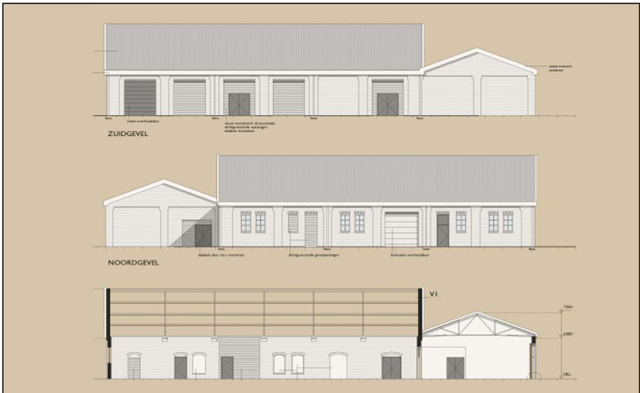
Fig. 27: Gevels en langsdoorsnede, Tramwerkplaats - KAW Architecten, Winschoten (Gemeentebrochure Tramwerkplaats, 2008)
