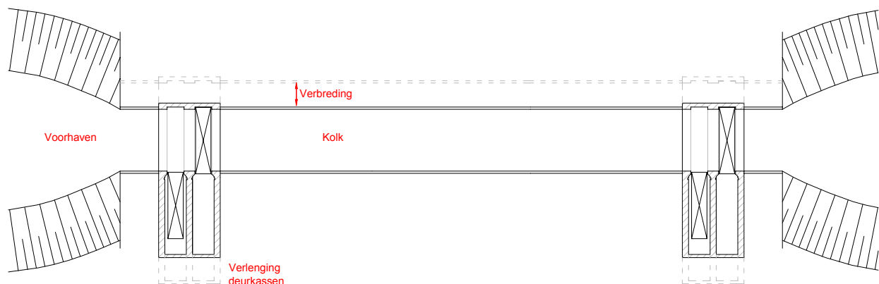
Figuur 8.1: Verbreding vlakke zijde (deurniszijde).
