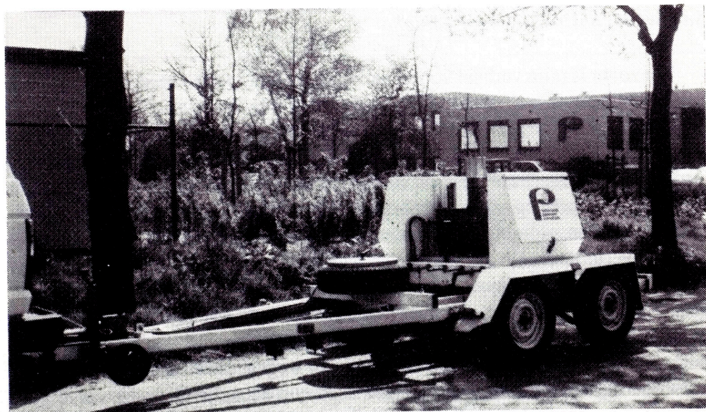
De valgewichtdeflectometer is een belangrijk hulpmiddel bij de evaluatie van wegen
