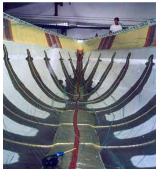
Afbeelding 4 Vacuüm-infusie van een 55-voet zeilbootromp (CLC TNO-TUD).
