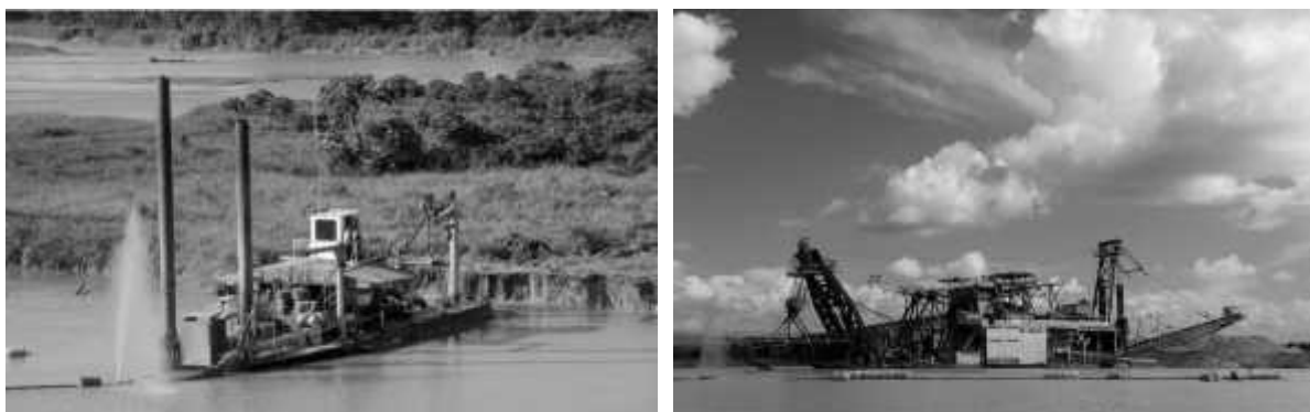
Figura 3.- Draga de succión y draga de cucharas en la zona de estudio. Recuperado de http://www.latinomineria.com/2017/01/19/mineros-sa-hay-que-tener-leyes-claras-para-inversionistas/ y de https://www.flickr.com/photos/mineros_sa/5884445963 .
