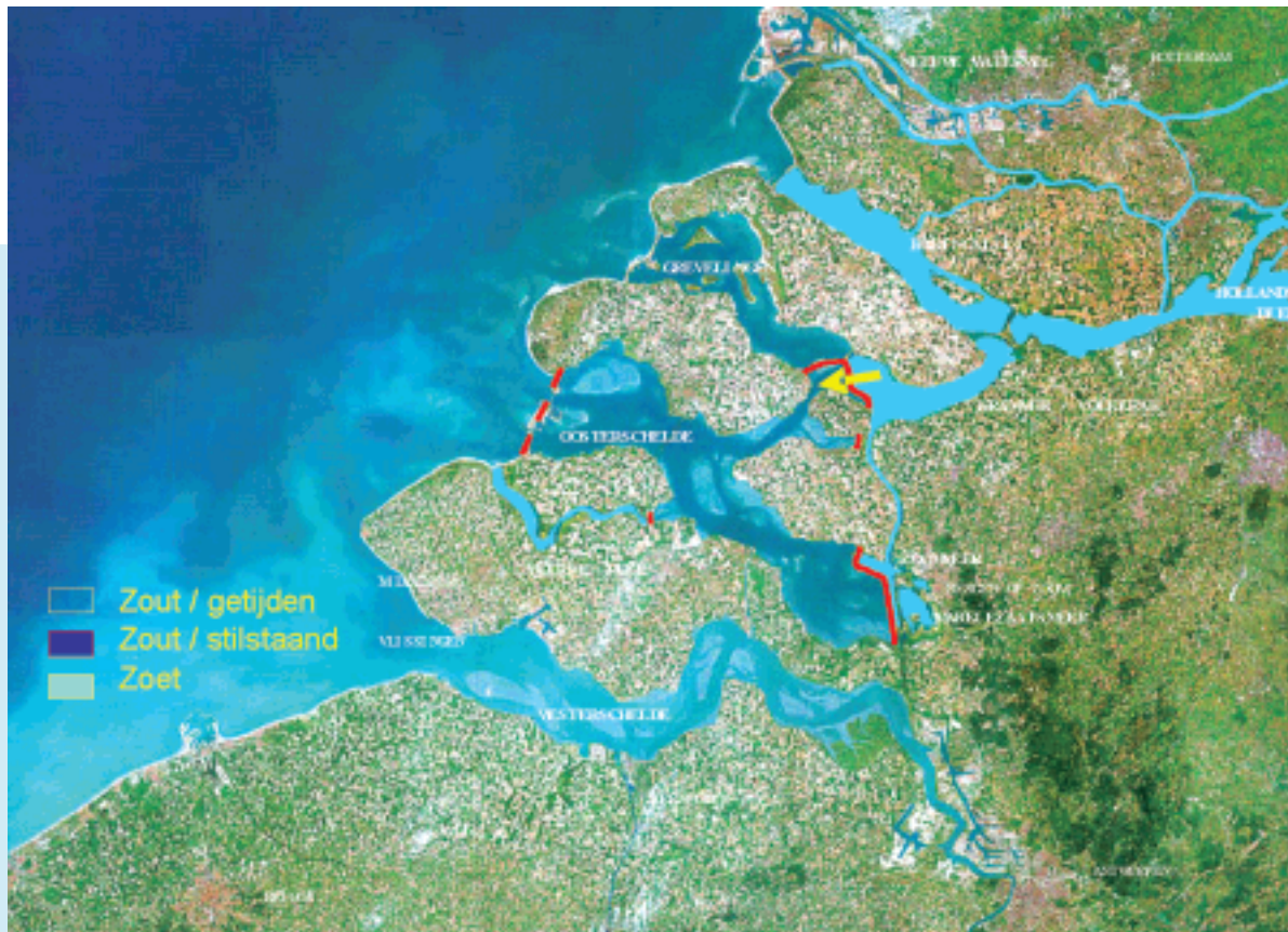
Foto 6.1 Positie van de Oosterschelde in het Deltagebied. Landinwaarts wordt deze begrensd door compartimenteringsdammen (rode lijnen) en aan de zeezijde door de waterdoorlatende Stormvloedkering (gestippelde rode lijn). De gele pijl geeft de locatie aan waar voor 1987 zoet water vanuit het Krammer-Volkerak naar de Oosterschelde stroomde. Bron: Provincie Zeeland.
