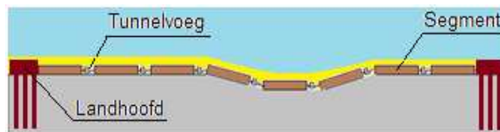
Figuur 17: Principe van het liggermodel van de tunnel
