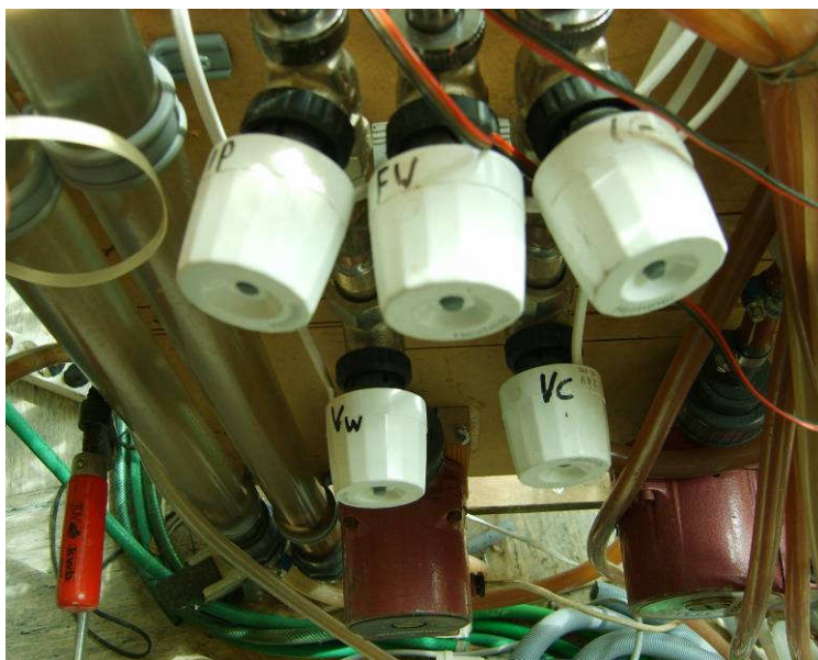
Figuur 5.19 De toegepaste regelknoppen met ptc-weerstanden
