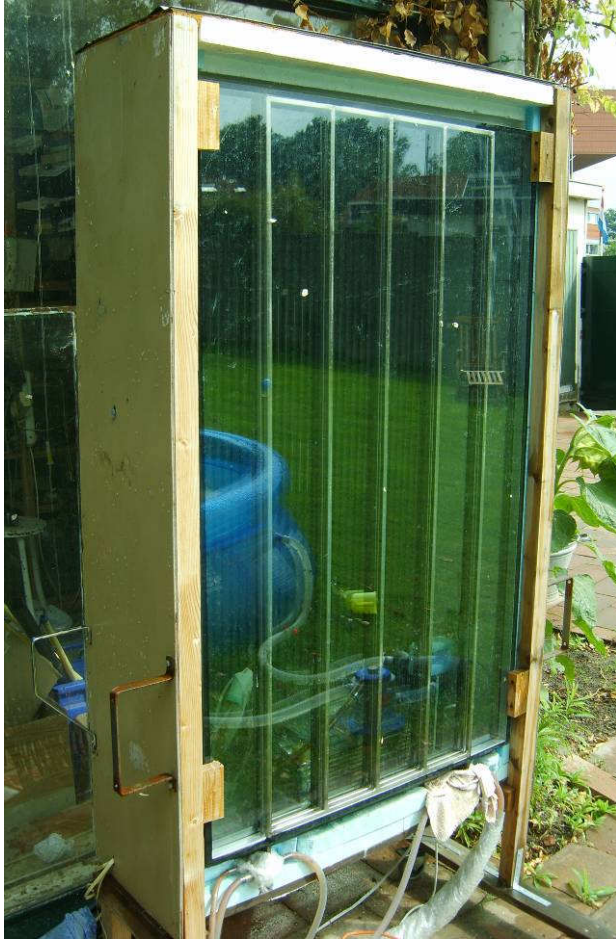
Figuur 5.10 Voorzijde proefopstelling: Smart Skin van glas
