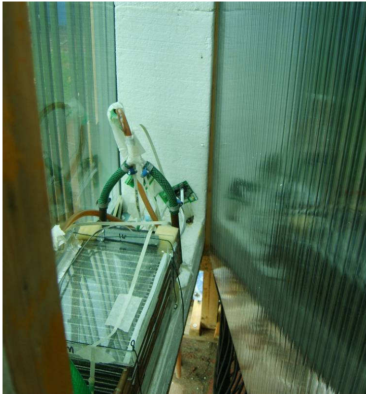
Figuur 5.13 Binnenzijde van de kast. De Fiwihex warmtewisselaar is zichtbaar, aan rechterzijde de polycarbonaat Smart Skin
