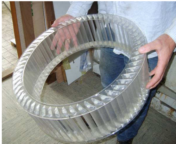
Figuur 4.2 Plastic schoepenrad dat zorgt voor luchtverplaatsing
