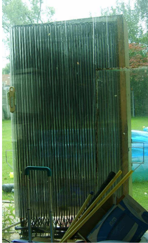
Figuur 5.11 Achterzijde proefopstelling: Smart Skin van polycarbonaat
