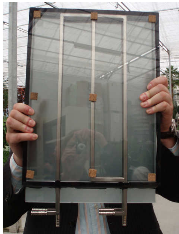
Figuur 5.2 Prototype Smart Skin matglas [26]
