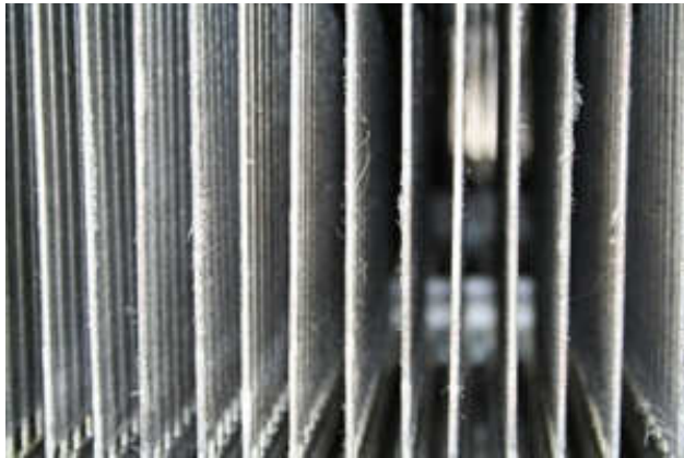
Figuur 4.5 Zijaanzicht van de matjes, de lucht stroomt in tegengestelde richting dan de kijkrichting [16]
