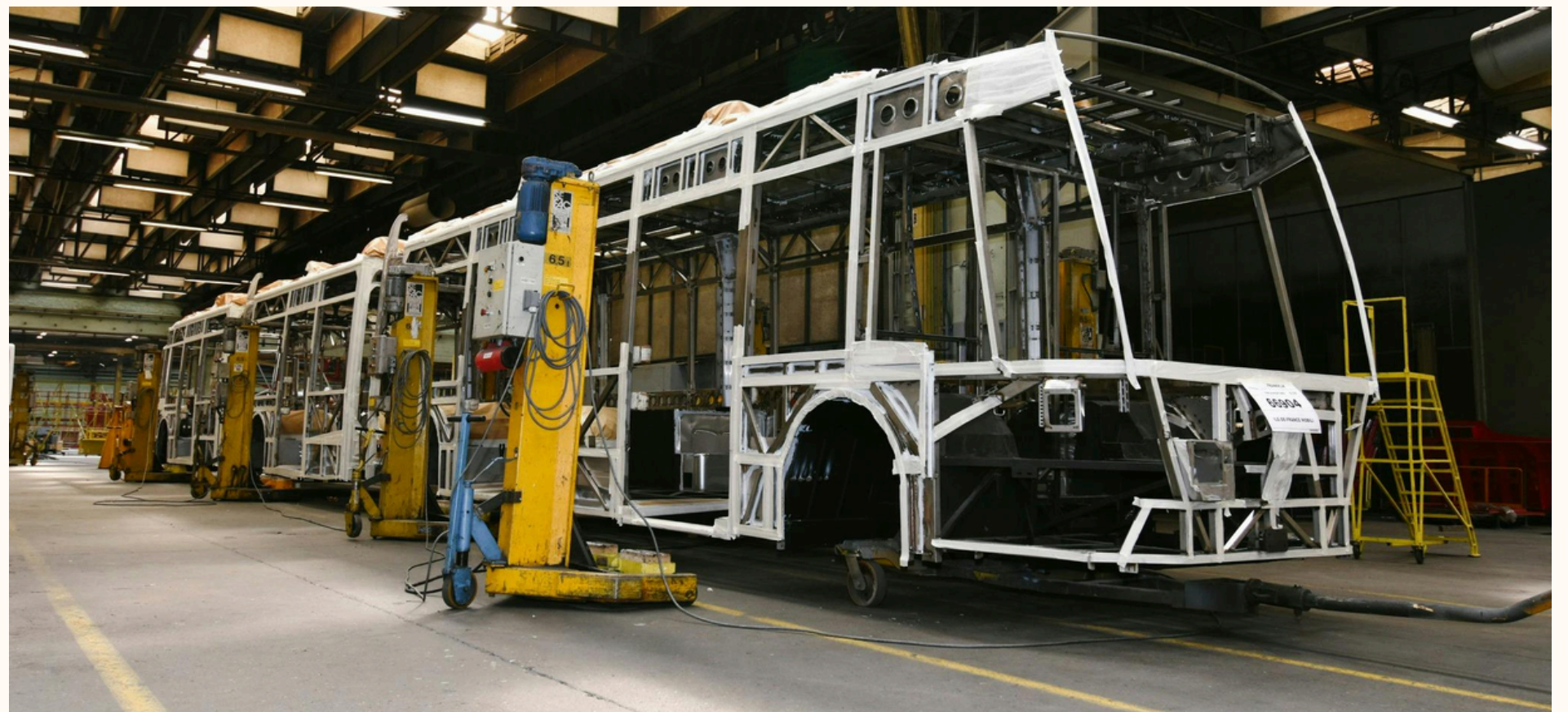
Figure 31: Skelet construction of a bus. (Île-de-France Mobilités, 2023)
