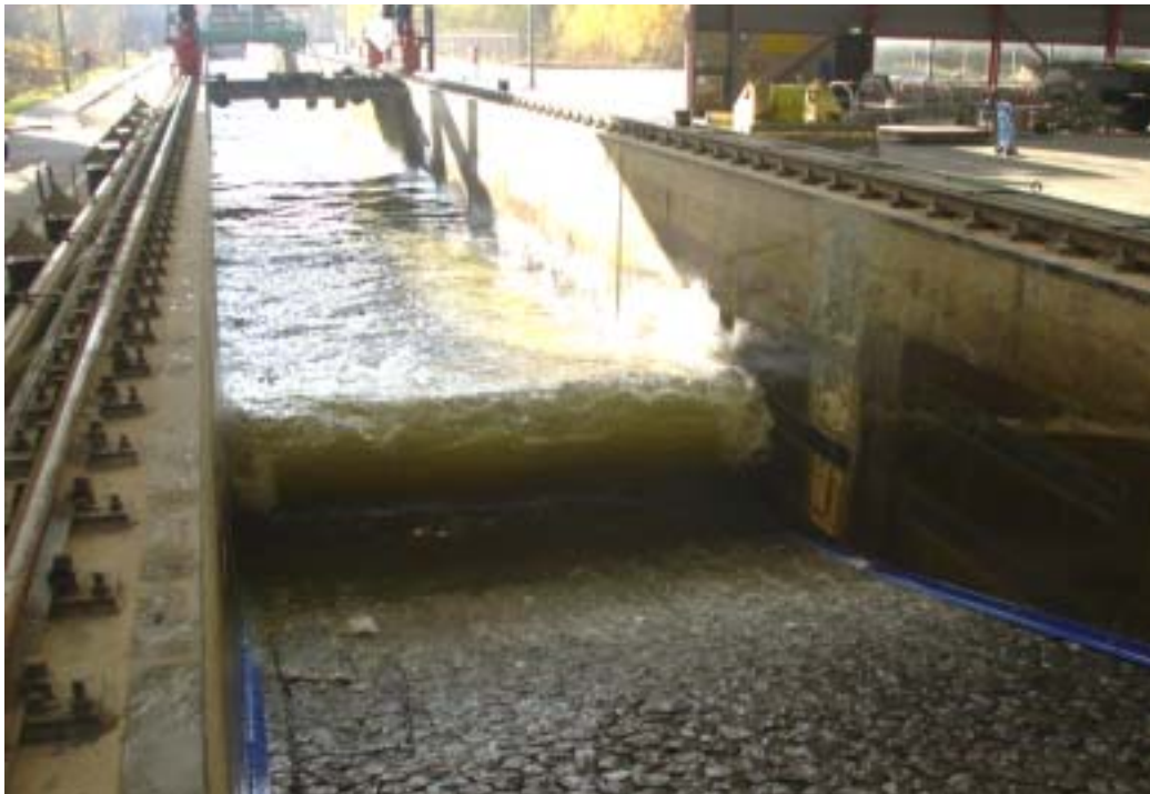
Geinstrumenteerde blokken met strips en golf tijdens proef 2
