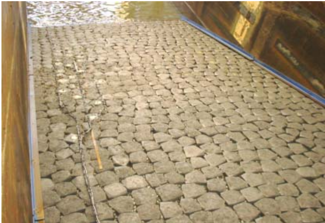
Drukopnemers in Basalton voor de proeven en taludoppervlak na proef 25
