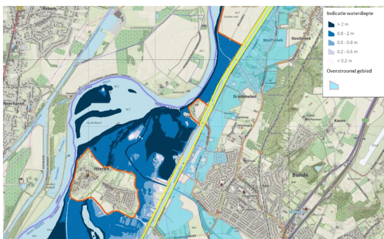
Figuur 3.2: Overstroomde gebieden ter hoogte van de monding van de Geul in de Maas.
