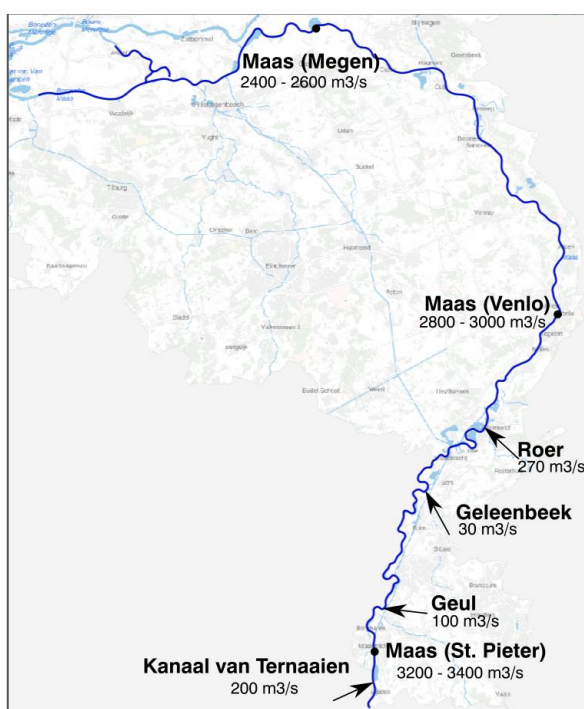
Figuur B.1.8.1: Inschatting van de afvoer op de Maas en de grootste instromende zijrivieren. De afvoeren op de Maas zijn schattingen uit operationele Qf- en Qh-relatie. De validatie hiervan op basis van ADCP-metingen is nog niet beschikbaar. De afvoer van de Roer is gemeten met een Qt-liner. De metingen van de Geleenbeek zijn afkomstig uit Qh-relatie. De afvoer van de Geul is een inschatting uit modelresultaten. De meting bij Ternaaien is een inschatting op basis van afvoermetingen elders op het Albertkanaal en analytische berekeningen.
