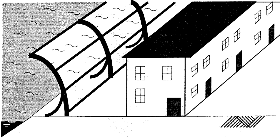
Waterkerende wand van gewapend glas
