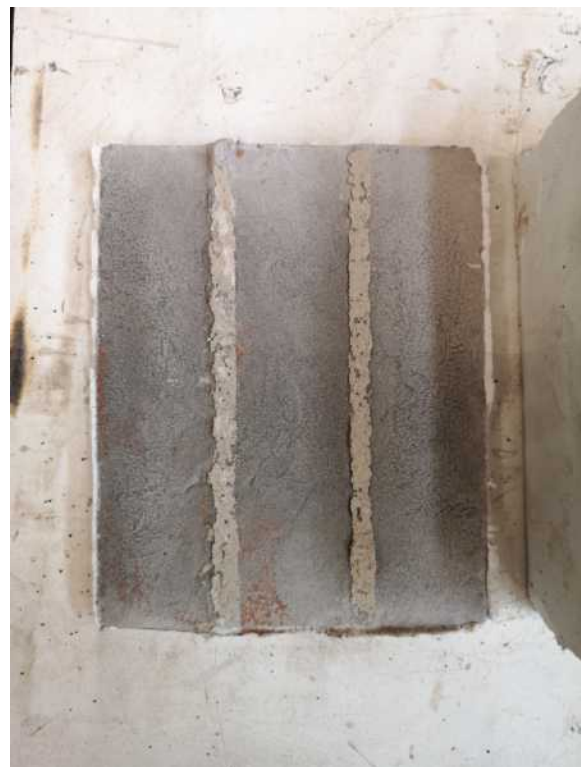
(d) Delaminated SHCC overlay.
