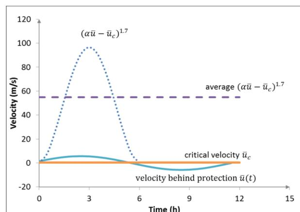
Figure 10- 13.Relevant scouring parameter
