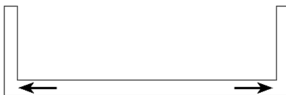
Figuur 8-5 Uitzetting van aan dragende borstweringen bevestigde balkonplaat
