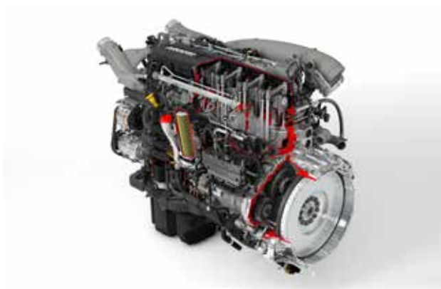
Afbeelding 1 Een MX-13-motor van DAF Trucks. Een 'doos' met gietwerk met lokaal een wanddikte van niet meer dan een paar millimeter (Foto: DAF Trucks N.V.)
