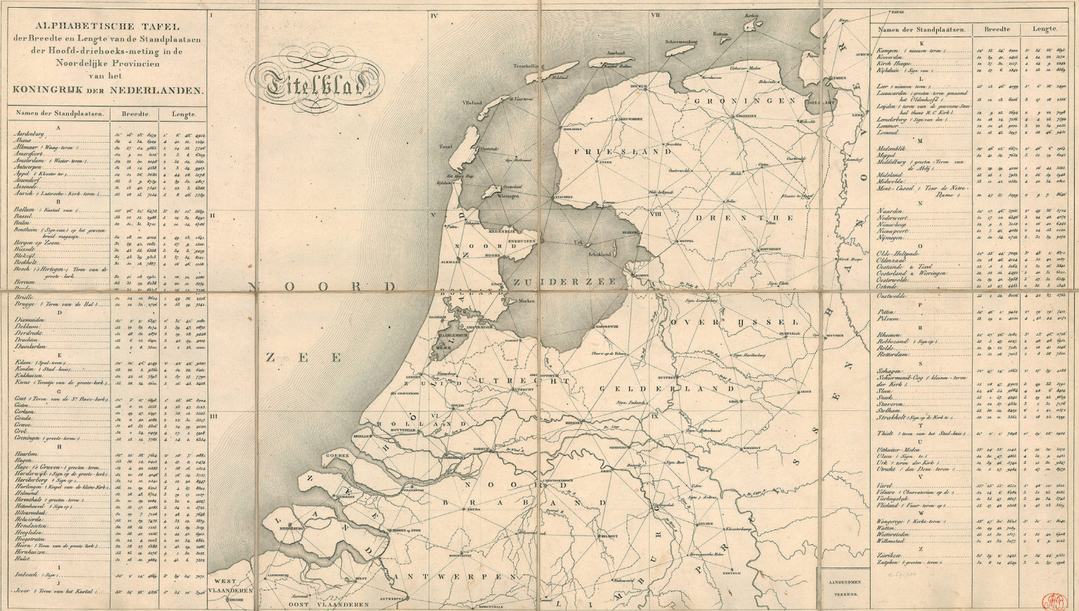
2. De triangulatie van Krayenhoff in het begin van de negentiende eeuw vormde de meetkundige basis voor het vervaardigen van de eerste nauwkeurige kaart van Nederland, de Topografische en Militaire Kaart TMK. Bladwijzer van de kaart van Krayenhoff met de coördinaten van de rijksdriehoeksmeting. Blad 1 van de Chorotopographische kaart van Holland verenigd met het Fransche Rijk , C.R.T. Krayenhoff, 1809 (Nationaal Archief, Kaartcollectie Zuid-Holland Ernsting (4.ZHPB4), inv.nr. 9)
