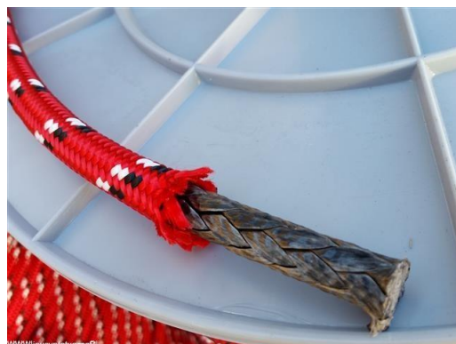
Image 2.13: Dyneema® rope (grey) with a braided Dyneema® shield (red). Source: linysyntetyczne.pl, 2019.
