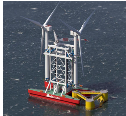
(d) Huisman's Wind Turbine Shuttle using a SWATH type vessel (Huisman, 2023)
