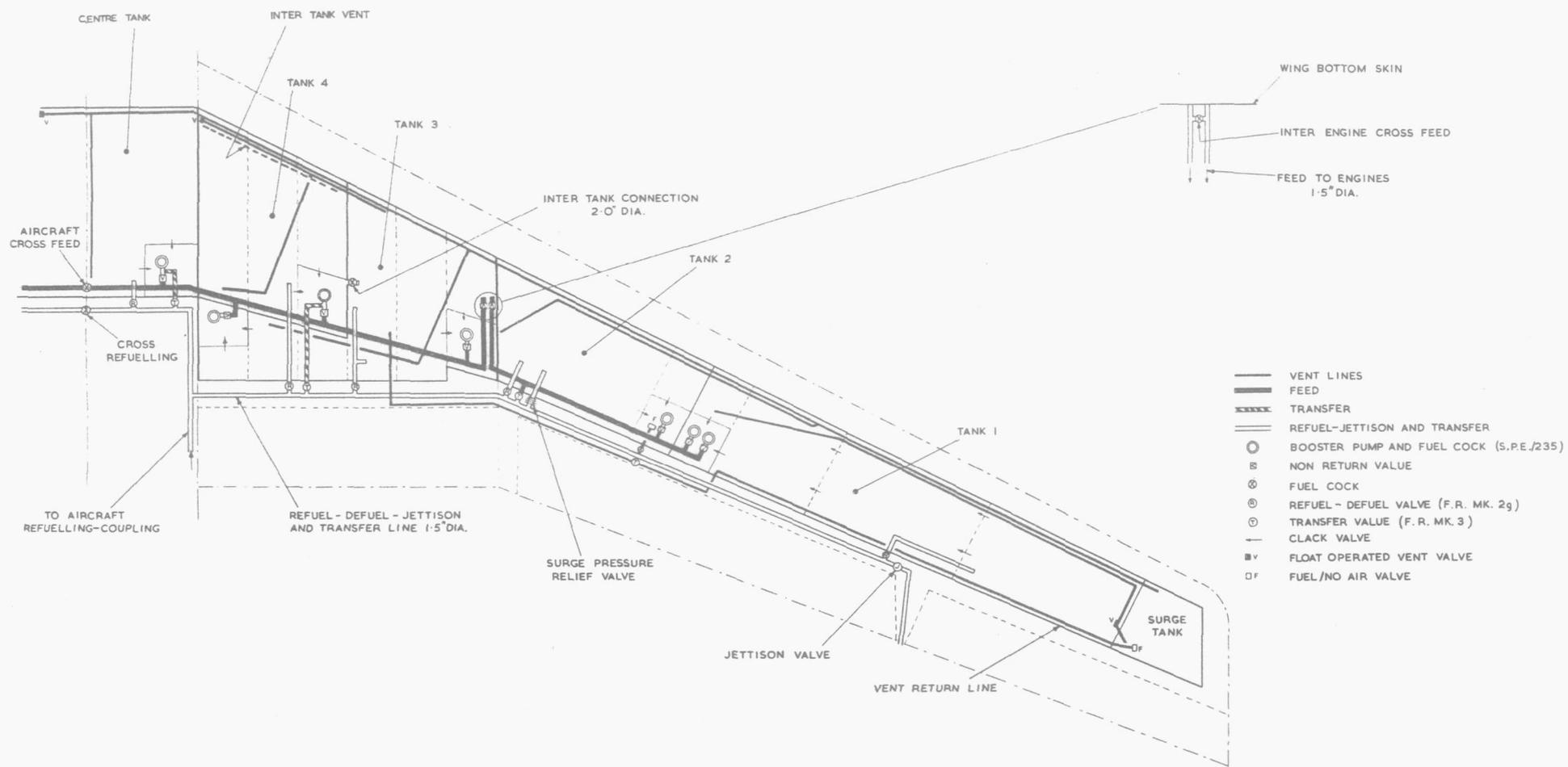
FIG. 18 FUEL SYSTEM OF THE GP 65
