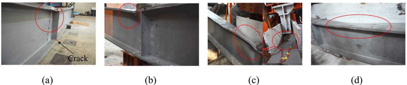
Fig. 10. Failure modes. (a) LPBS; (b) NPBS; (c) LPBD; (d) NPBD.
