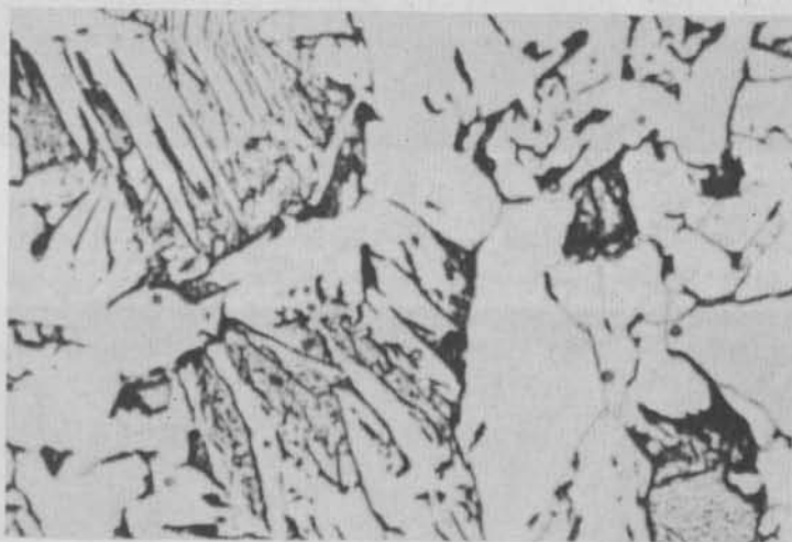
Figuur 3.7. Normaalgegloeid staal met 0,30 %C; etsing \text{HNO}_3 in alcohol (300x).
