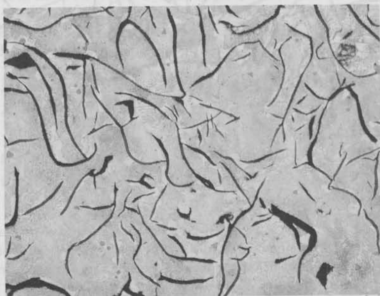
Figuur 12.6. Gewoon grijs gietijzer (200 \times ).
