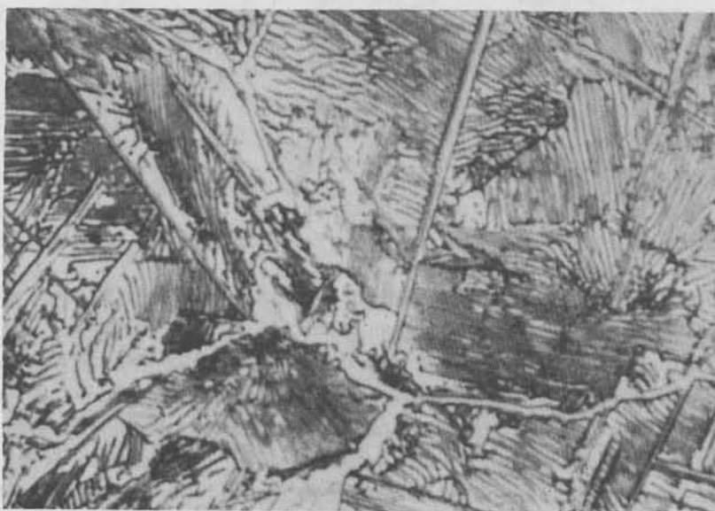
Figuur 3.8. Structuur van normaalgegloeid boveneutectoidisch staal; (a) 1,2% C; (b) 1,6% C; etsing \text{HNO}_3 in alcohol (1000 \times ).
