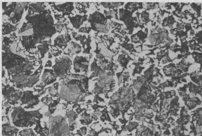
Figuur 4.2. Staal met 0,45 %C; 830 °C/luchtcoeling. Ferriet + fijne perliet. HV: 210 (etsing \text{HNO}_3 in alcohol; 500x).
