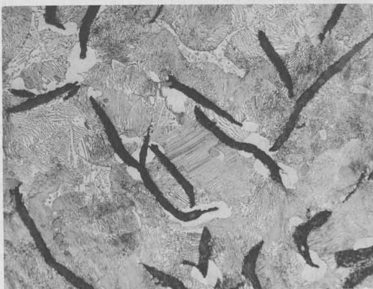
Figuur 12.5. Perlitisch grijs gietijzer (500 \times ).
