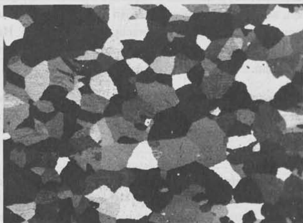
Figuur 13.9. Rekristallisatiestructuur van aluminium.
