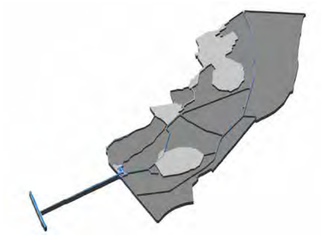
ILLUSTRATIE 4.37 Tussenboezemstelsel rondom de polder Berkel dat aanhaakt op de Schie, de hoofdboezem, in 3D.
