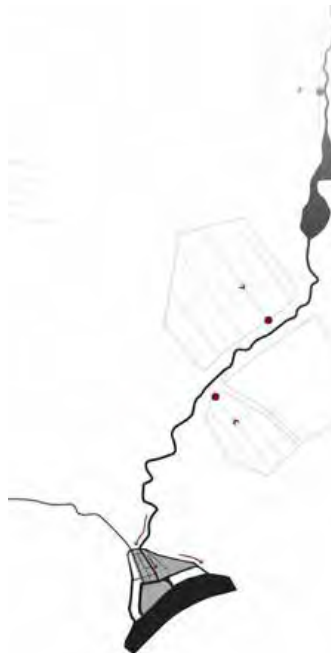
ILLUSTRATIE 6.54 Gereguleerde afwatering door inpoldering via molens, boezem en uitwateringssluizen.
