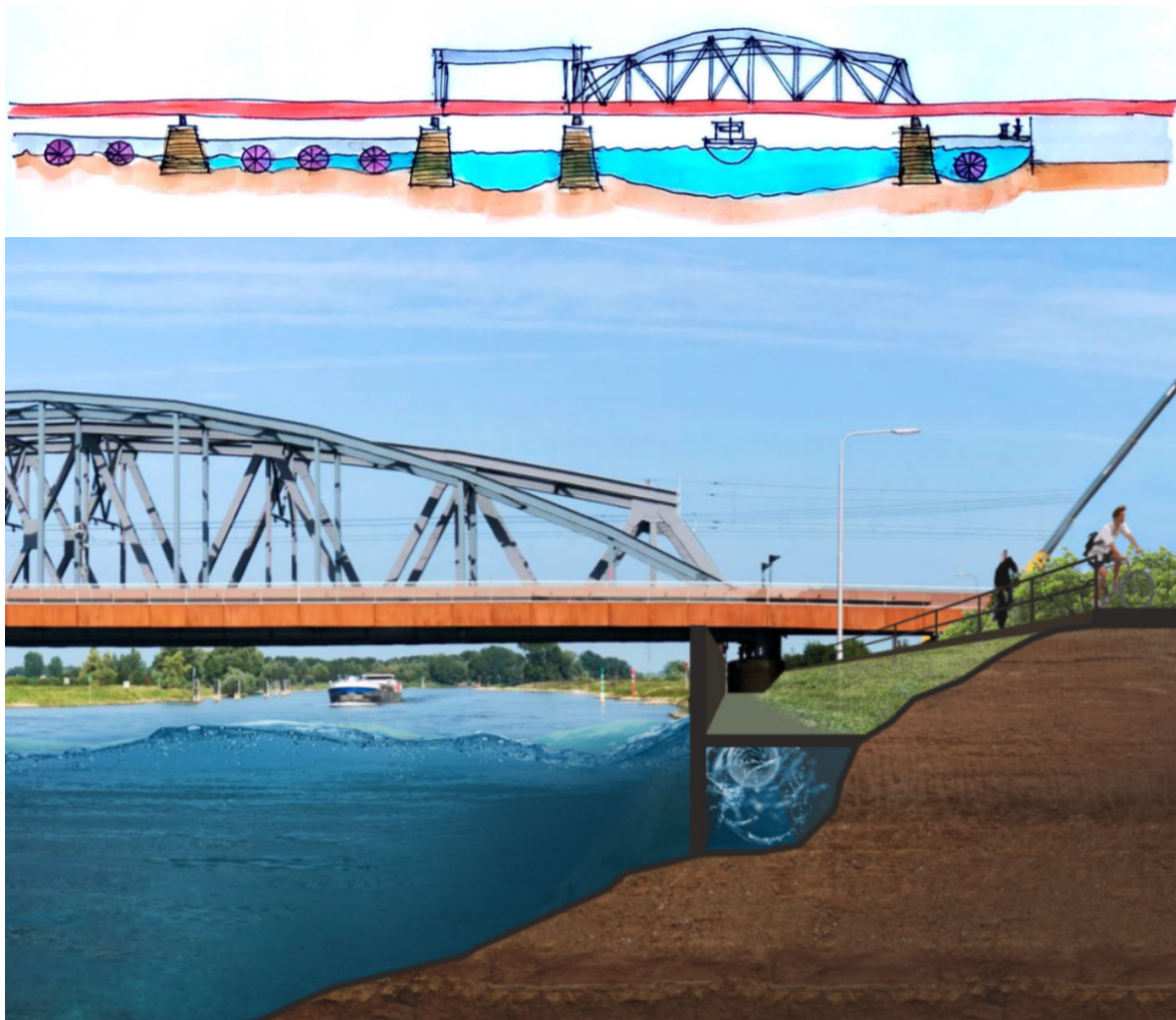
Afbeelding 26: Bypass waterturbine voor elektriciteitsopwekking langs de IJssel [Martin et al. 2021]
