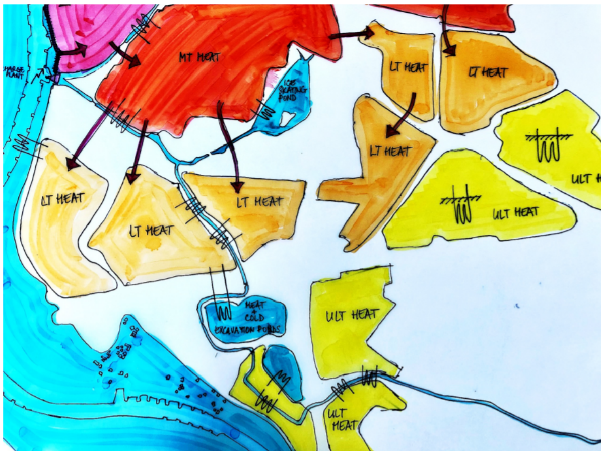
Afbeelding 27: Cascadering van warmte over de wijken en buurten van Zutphen [Martin et al. 2021]
