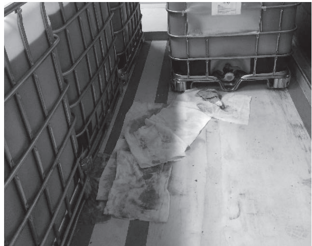
Figuur 6 Cubitainer met een lekkende sluiting
