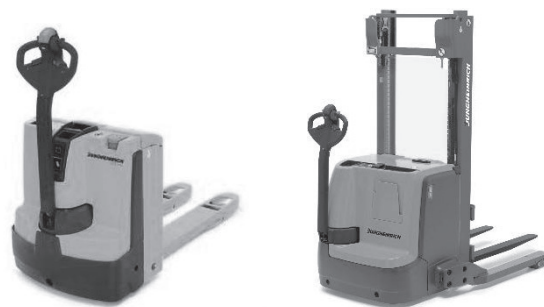
Figuur 1 Links: standaard elektrische palletwagen, rechts: stapelaar
