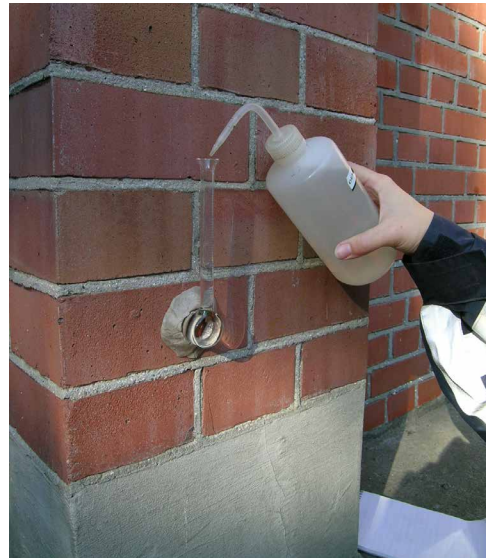
FIG. 4.20 Karsten Tube test / Photo: R. van Hees
