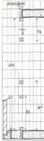
AFBEELDING 8.229 Detail van de aansluiting kozijn – bakstenen penant.
