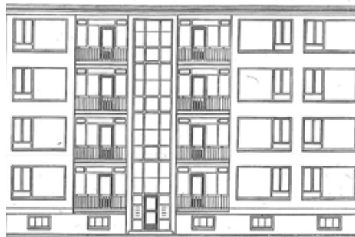
AFBEELDING 5.43 Voorbeeld van een gevel in gietbouw met bakstenen gevelafwerking, in 1959 gepubliceerd.
