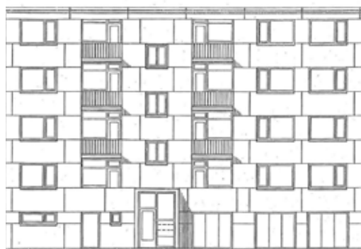
AFBEELDING 5.46 Voorbeeld van een gevel in montagebouw met middelgrote gevelelementen, in 1959 gepubliceerd.
