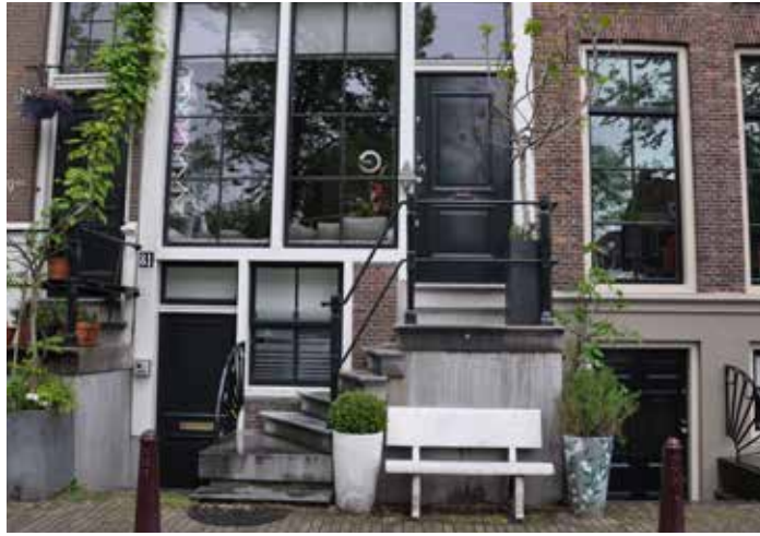
AFBEELDING 4.6 De zone van de stoep, een voorbeeld in Amsterdam. De begane grondwoning ligt verhoogd, de kelderwoning heeft een raam en deur naar de straat.
