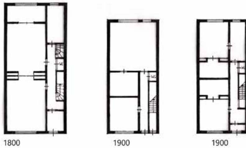
AFBEELDING 7.18 De schematische tekeningen laten de ontwikkeling van de gang zien. Achterkamer, hof en zaal werden gereduceerd tot voor- en achterkamer, de kamer en suite (1800). Rond 1900 zien we twee verschillende schema's: de ene laat de tweede ingang en de trap naar de bovenwoning zien, de andere laat de alkoof als een private slaapruijnte zien. Voor- en achterkamer konden door twee gezinnen bewoond worden.
