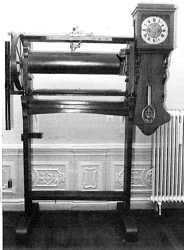
Het instrumentarium van het station Urk, in gebruik van 1858 tot in 1932. De trommel wordt aangedreven door de Friese staartklok.
