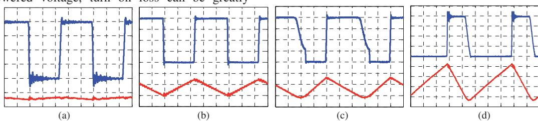
Fig. 7 Measurement results: (a) CCM; (b) BCM; (c) BCM-VS I ( $V_{out} < 2V_{in}$ ); (d) BCM-VS II ( $V_{out} > 2V_{in}$ )
