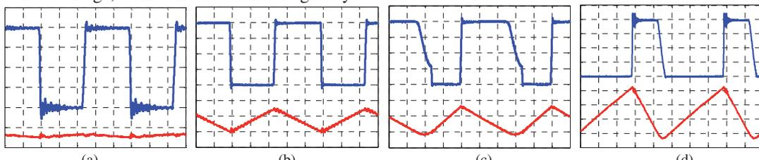
Fig. 7 Measurement results: (a) CCM; (b) BCM; (c) BCM-VS I ( $V_{out} < 2V_{in}$ ); (d) BCM-VS II ( $V_{out} > 2V_{in}$ ) ( $V_{ds}$ : 200V/Div;  $i_L$ : 2A/Div; time: 200ns/Div)
