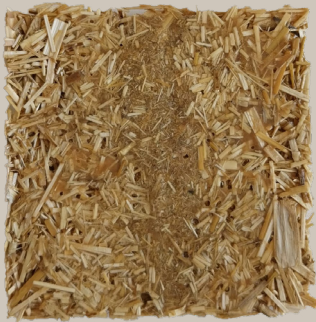
(Bio) Epoxy binder 3 g epoxy resin · 5 g hardener
