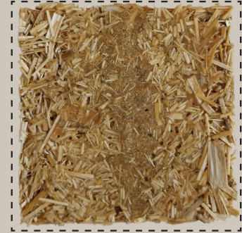
(Bio) Epoxy binder 3 g epoxy resin · 5 g hardener
