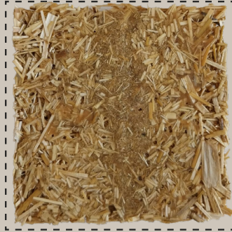
(Bio) Epoxy binder 3 g epoxy resin · 5 g hardener
