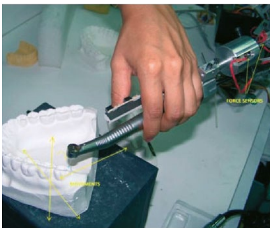
Figuur 6 De end-effector met daaraan vast het hoekstuk.
