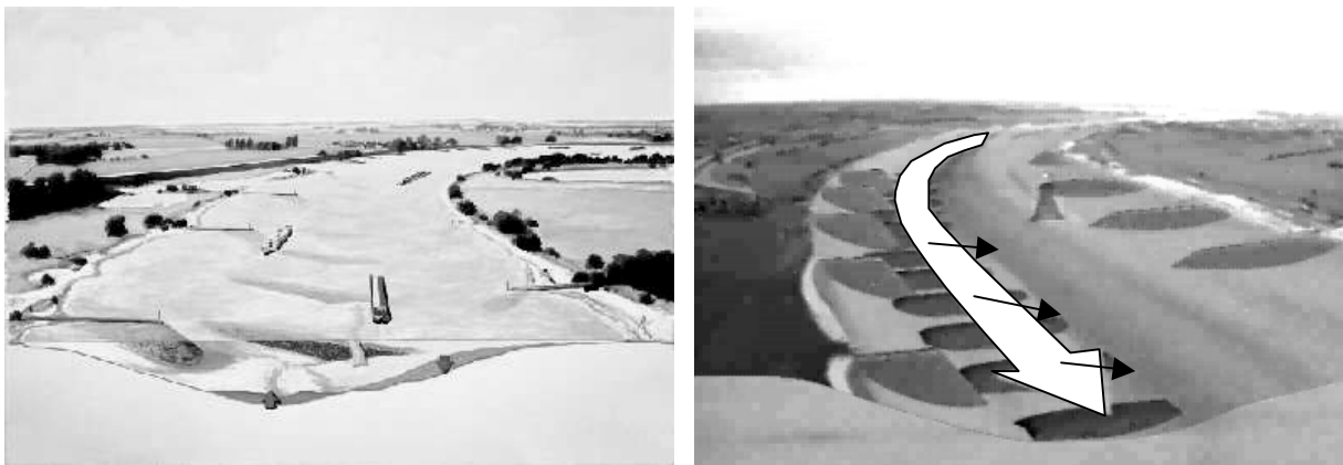
Abbildung 9 – Bodenschwellen und Wirkungsweise (Verlagerung der Hauptströmung in Richtung Innenkurve)
