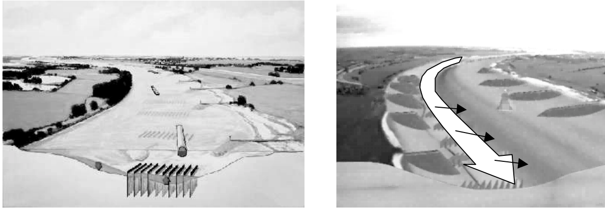
Abbildung 10 – Bodenleitwände und Wirkungsweise (Verlagerung der Hauptströmung in Richtung Innenkurve)
