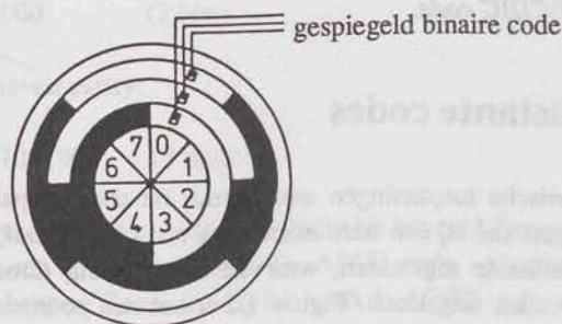
Figuur 1.3. Codeschijf in de Gray code (gespiegeld binaire code).
