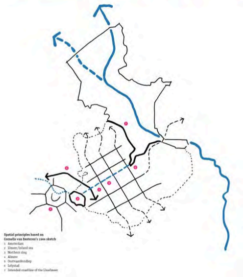
Afbeelding 10.1.3 Stedenbouwkundige plananalyse van een niet-uitgevoerd ontwerp op regionale schaal van Cornelis van Eesteren voor Amsterdam en de IJsselmeerpolders uit 1966 (boven). In de analysetekening (onder) wordt gebruik gemaakt van de technieken 'reduceren' en 'toevoegen'. Zo is het plan geplaatst in een grotere kaart van het IJsselmeergebied en zijn verkeers- en waterstromen aangegeven met pijlen in verschillende kleuren.
