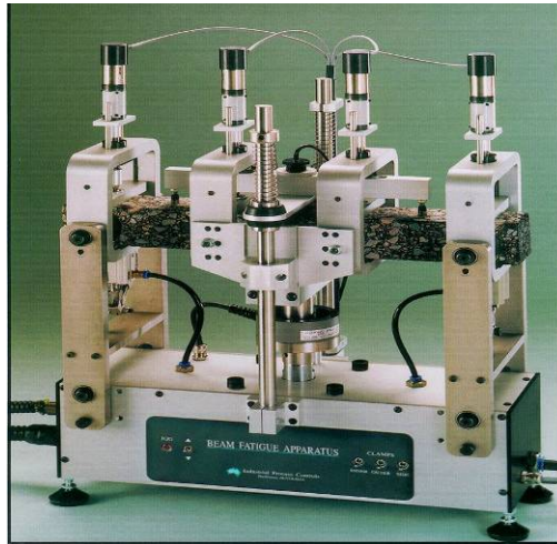
图 1 四点弯曲扫频实验设备
