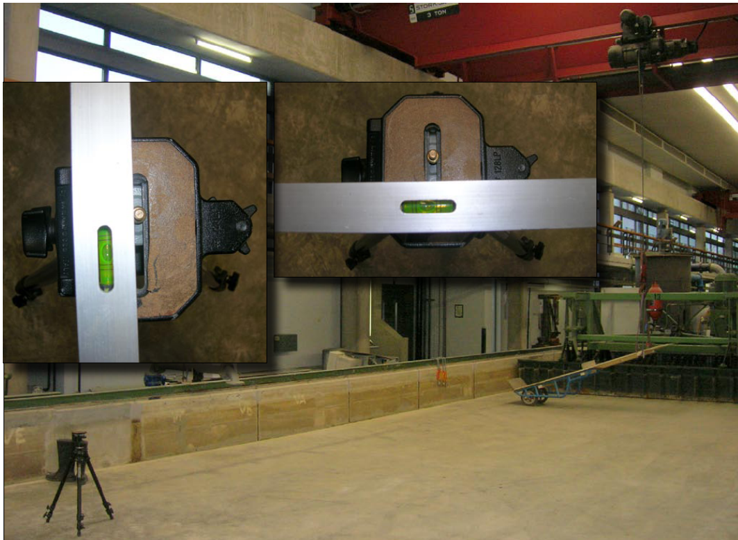
图 6 未硬化碎石聚氨酯斜坡稳定性实验设置
