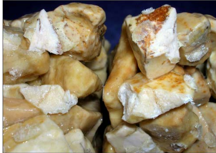
图 5 单调三点弯曲强度实验中黄色试件 6 受破坏的横截面
