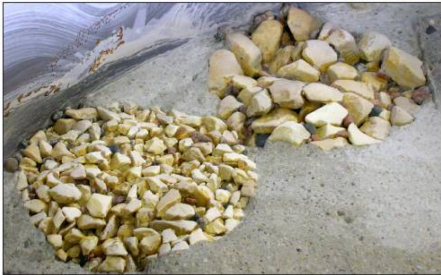
图 15 由 8/11mm 和 16/32mm 碎石配制的碎石聚氨酯试件的抗磨损实验结果
