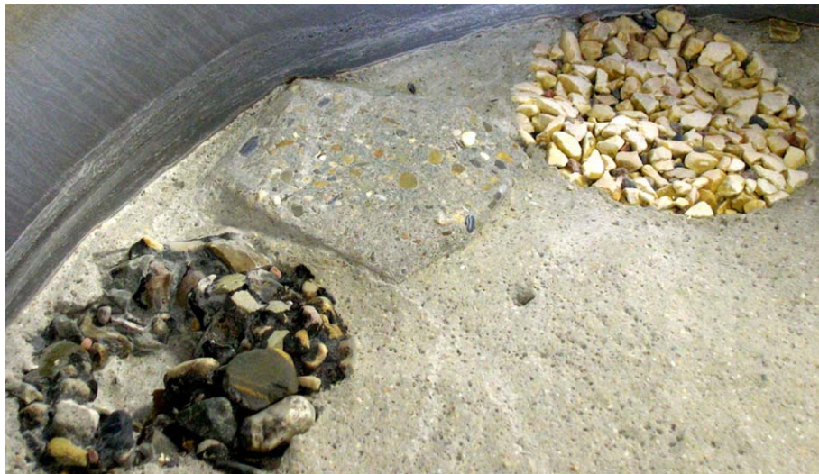
图 14 碎石沥青，预制混凝土块和碎石聚氨酯试件相对耐磨损能力实验结果
