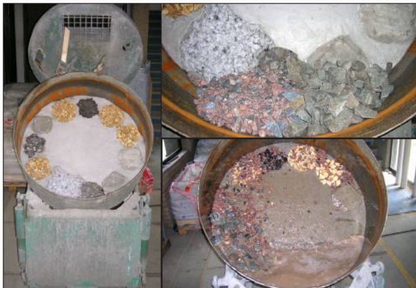
图 13 相对抗磨损能力实验装置
