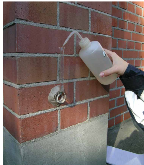
FIG. 4.20 Karsten Tube test / Photo: R. van Hees
