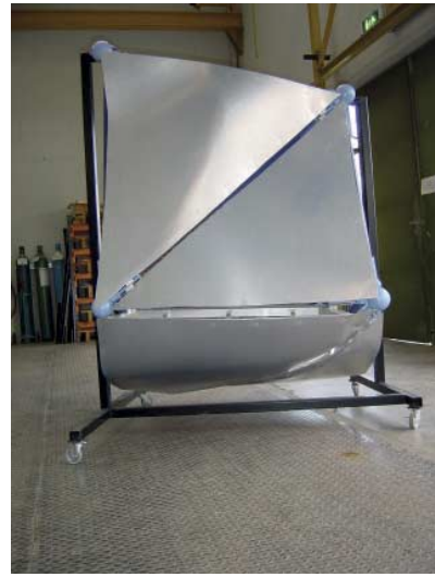
FIG. 68 De buitenzijde van hetzelfde model (fig. 67): onmogelijk om de vloeiende geometrie met koudverbuigen van metaal een vloeiende vorm van de algehele carrosserie te verkrijgen
