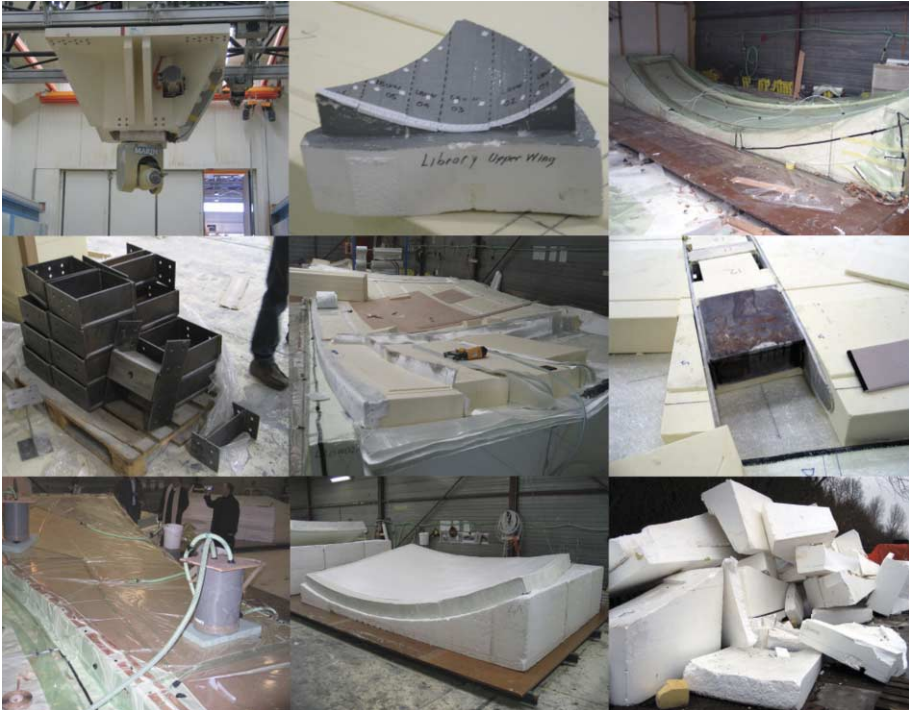
FIG. 126 Foto's over de productie van de polyester schalen: het frezen de mallen, de versterkingen, het inleggen op de mal. Het vacuüm zuigen van de totale sandwich inclusief beide glasvezelhuiden en uiteindelijk een deel van de overgebleven polystyreen mallen
