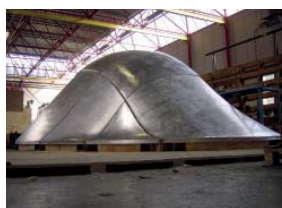
FIG. 38 De door middel van explosie op een betonnen mal vervormde aluminiumpanelen, op maat gemaakt om een deel van het gemeentelijk 'Blob'paviljoen op de Floriade te vormen, hier nog in proefopbouw in de fabriek [productie Exploform/Octatube]
