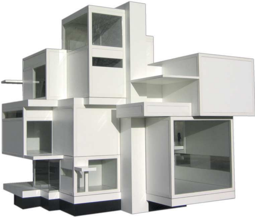
FIG. 65 Model 1 op 5 van het Maison d'Artiste zoals ontworpen door Theo van Doesburg en Cor van Eesteren in 1923, gereconstrueerd in haar geometrie vanaf zwart-wit foto's door mijn studenten (onder wie Joris Braat) in 2002 en gebouwd als prototype in het Prototype Laboratorium in 2003
