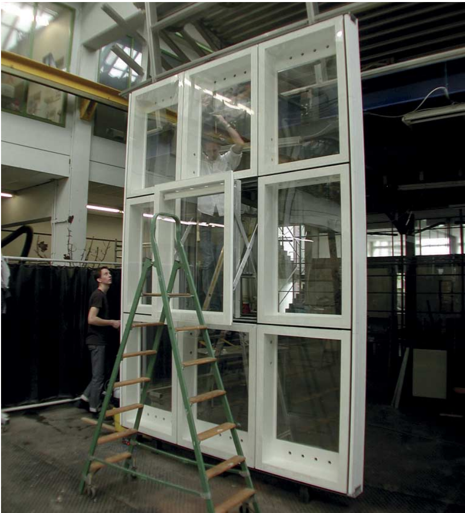
FIG. 66 Metalen glasgevel in het prototypelaboratorium met horizontaal uitschuifbaar raam
