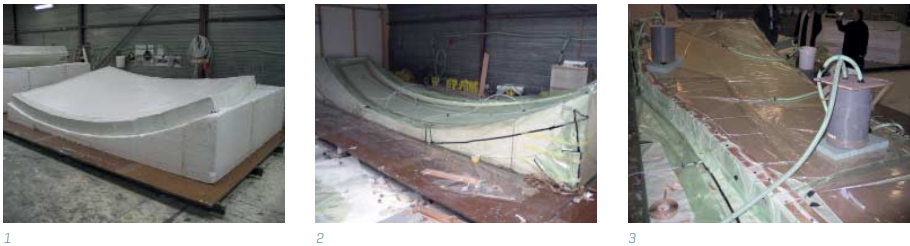
FIG. 121 De polystyreen mal, de eerste glasvezelmatten en tenslotte het vacuÛmzuigen van de glasvezelmatten met polyester
