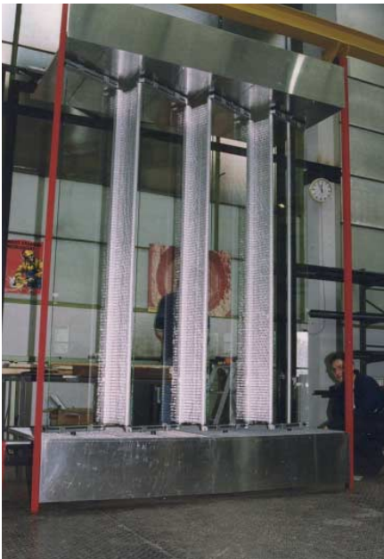
FIG. 90 Prototype van een zonwering wordt in het PO Lab getest in open positie idem
