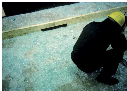
FIG. 50 De scherven op de grond bij de explosie fig.49 vlogen ook 15 m verder door de hoge overdruk in het TNO laboratorium in Rijswijk
