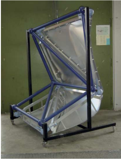
FIG. 67 Detail van vakwerkconstructie van het provinciaal Floriadepaviljoen volgens geometrie Kas Oosterhuis, en in de cladding de algemene vorm van de cladding volgend. Het bleek een complexe en bijna onuitvoerbare opgave, zeker niet eenvoudig en onhaalbaar binnen de gegeven financiële projectvoorwaarden
