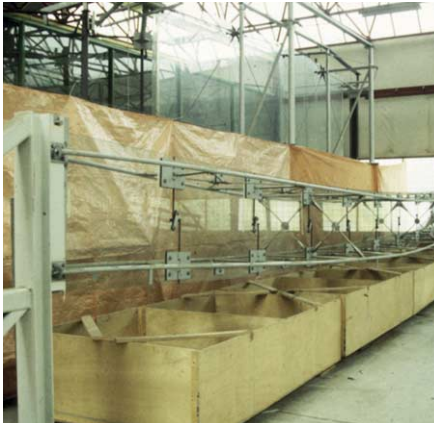
FIG. 51 De schaal 1 op 2 proefopstelling van de glazen ligger van het Zwitserleven hoofdkantoor, Amstelveen, in werkelijkheid 27 m overspannend op 25 m hoogte recht boven de hoofdingang, uitgevoerd met de details 1 op 1 met waterbakken te belasten met een eigengewichtzeeg en onvoldoende draagvermogen, waardoor het ontwikkelend onderzoek na 3 jaar werd afgebroken
