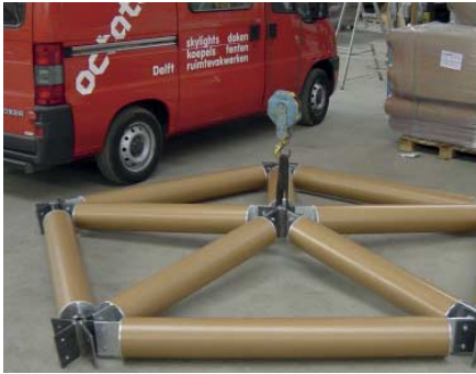
FIG. 106 Pre-assemblage van 10 kartonnen staven en 5 knooppunten om een constructieve doorkniktest te doen
