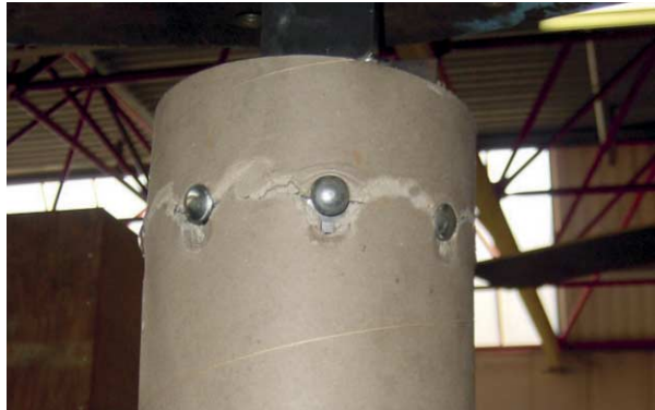
FIG. 94 Scheurpatroon van een geboute verbinding die de zwakte en ongeschiktheid van deze geboute verbinding toont
