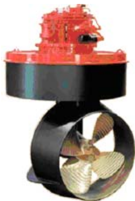
Figuur 5.6: Een roerpropeller
