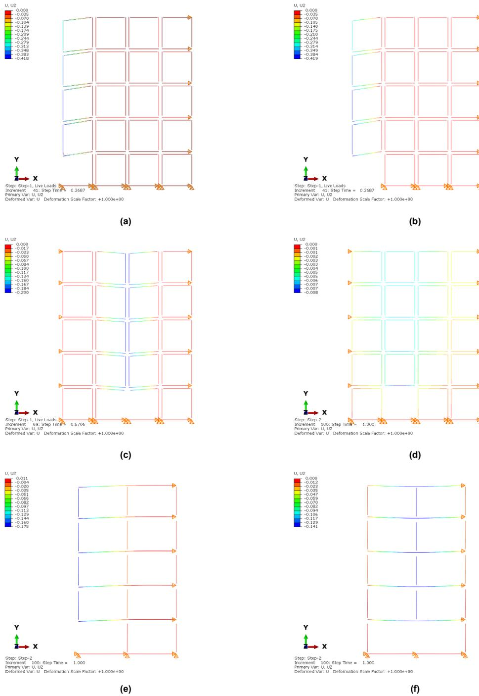
Figure C.3: Vertical displacement output for removal scenarios a) till f)
