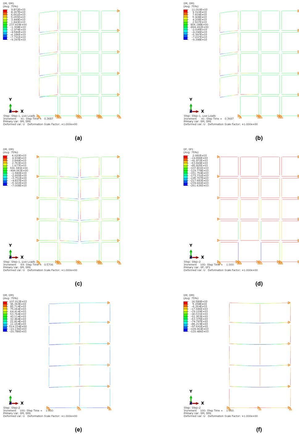
Figure C.4: Section moment output for removal scenarios a) till f)
