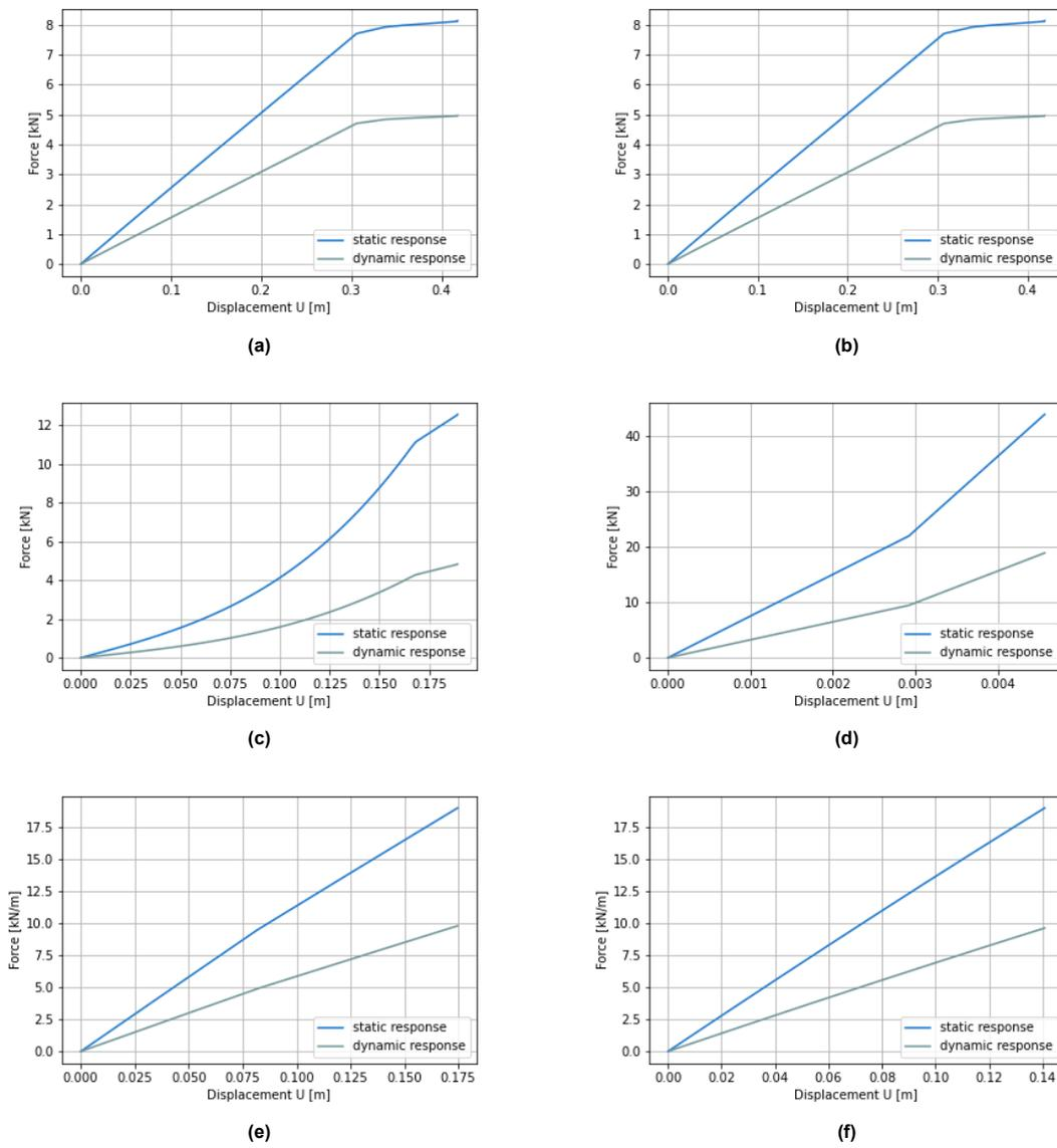
Figure C.1: Push down curves for column removal scenarios a) till f)
