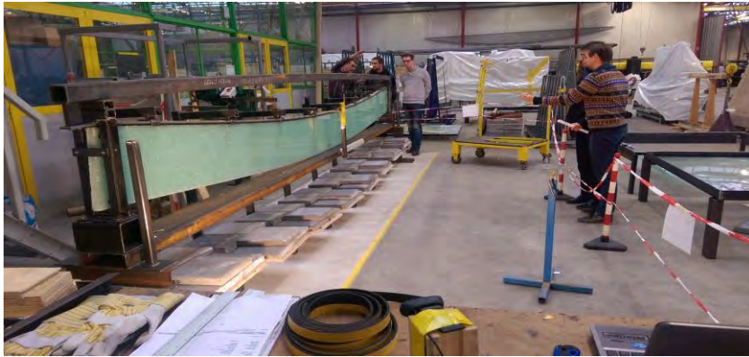
Volledig belaste, geheel gebroken, maar niet ingestorte glazen ligger in het laboratorium dec. 2014
