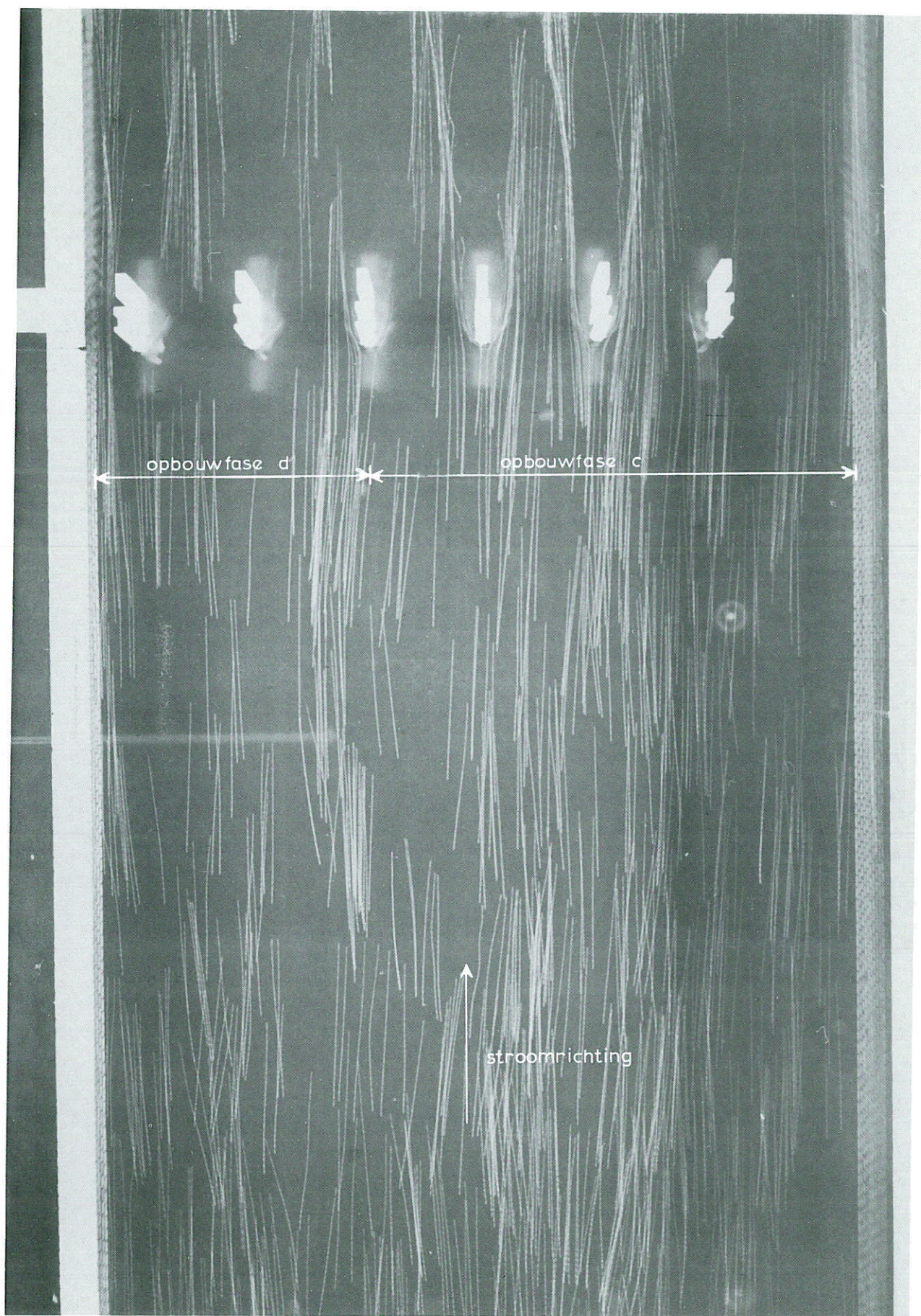
3. T15 Stroombeeld met papiersnippers. \bar{u}_0 = 0,297 \text{ m/s}
