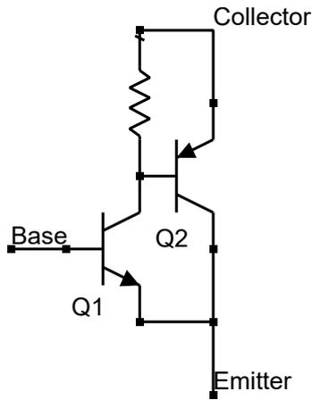
Figure 2.12: Circuit diagrams of a NPN Sziklai transistor
