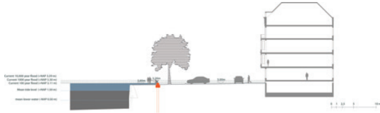
Figure 1. Cross section of Noordereiland: option flood protec- tion by floodwall, small bench (image courtesy Peter van Veelen).
