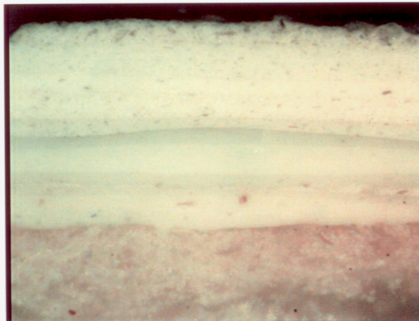
Afbeelding 8. Verfdoorsnede in opvallend gepolariseerd licht van het eerste afwerkstadium en de overschilderingen van de kolom van het kantoor ( monsternummer 2259/44 ). Vergroting 130x.
