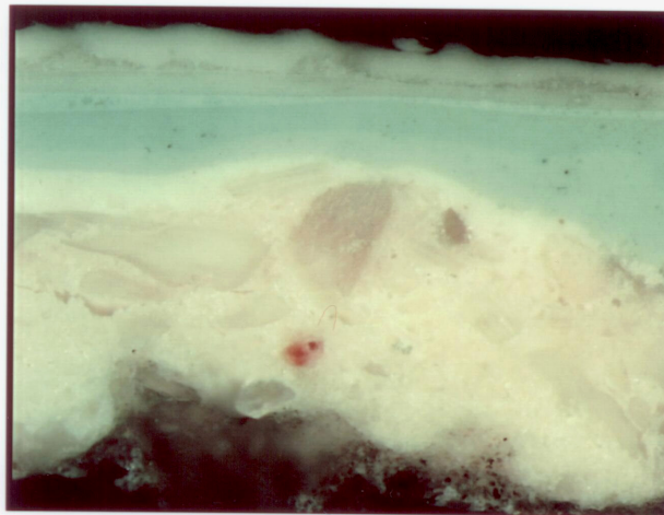
Afbeelding 7. Verdwaarsdoorsnede in opvallend gepolariseerd licht van het eerste afwerkstadium en enkele overschil- deringen van de wand van de kolom van het kantoor ( monsternummer 2259/43 ). Vergroting 130x.
